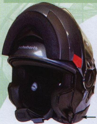
Entfernen Sie den Clip, um die beiden darunter liegenden Schrauben freizulegen. Entfernen Sie die Schrauben, damit Sie die Clips der Dichtung lösen können, wenn Sie die Wangen-Pads abnehmen.
