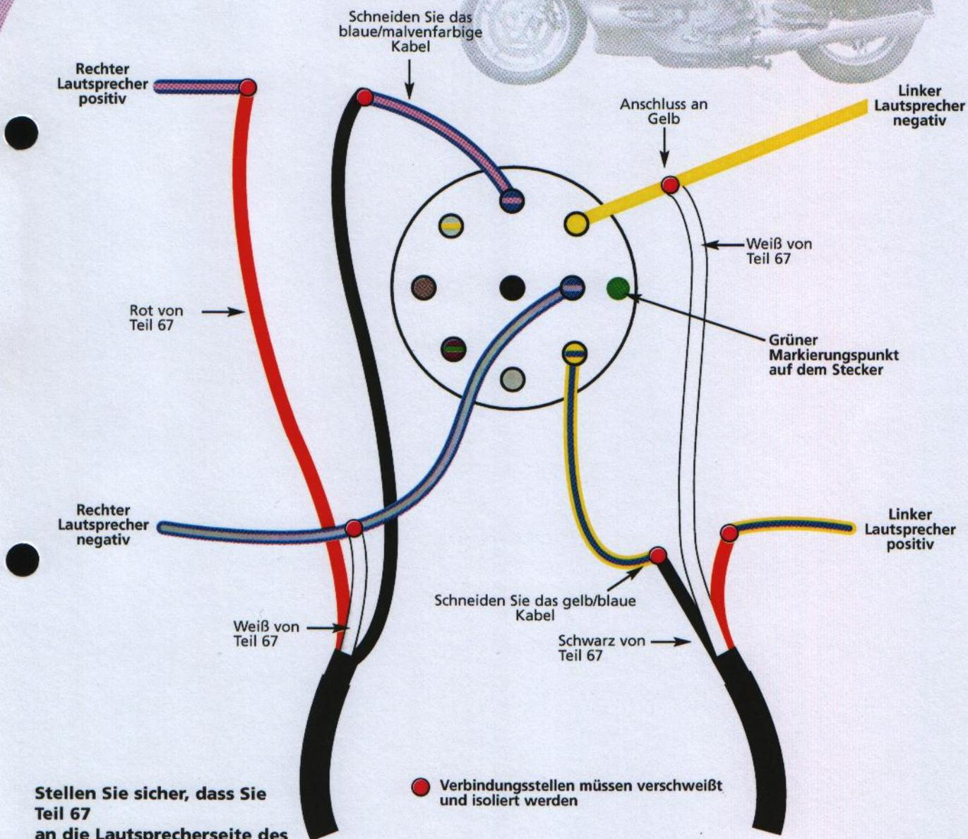
**Stellen Sie sicher, dass Sie Teil 67 an die Lautsprecherseite des Steckers anschließen (siehe unten)**
